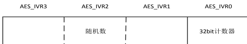
图 14-8 32 位计数器和随机数的存储方式
